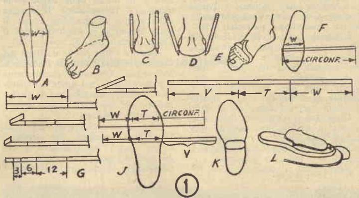
senza muovere il piede l'operazione, tenendo questa volta la matita inclinata verso l'interno come nel particolare *D*. Questo secondo tracciato vi servirà per la costruzione della forma di legno. Correggete quindi ogni curva irregolare, dopo aver tolto il piede.
