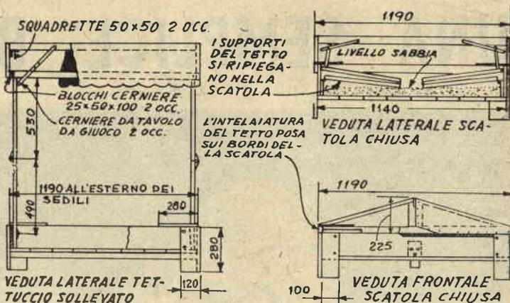
che sono uniti di testa, i giunti essendo irrigiditi per mezzo di triangoli ricavati da avanzi di compensato o masonite di 0,5 cm. di spessore. Fissate poi i due supporti di 2,5x7,5 ed infine la traversa che segna lo spiovente del tettuccio ed i quattro tiranti. Completate l'intelaiatura con l'aggiunta dei blocchi di fissaggio delle cerniere.
