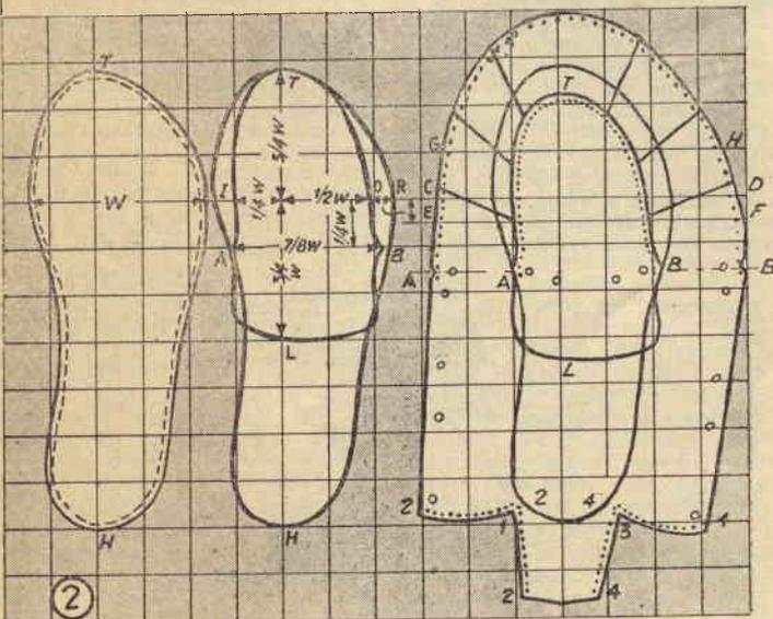
punto, misurate sulla destra una larghezza pari a  $7/8$  di  $W$ , indicando il punto ottenuto con  $B$ . La misura  $A-B$  rappresenterà la larghezza della maschera al punto dei denti che debbono coincidere con le tacche della tomaia.
