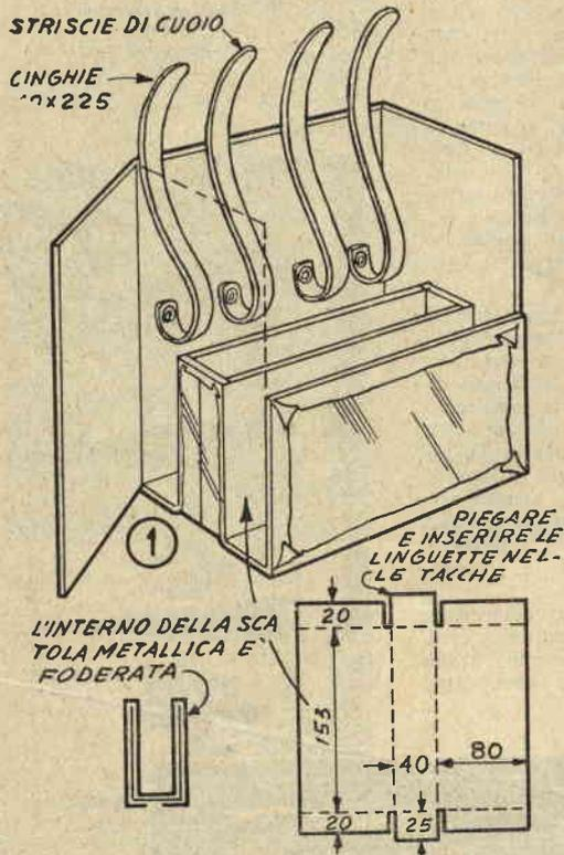
**M**olti utilissimi perfezionamenti distinguono questo astuccio dall'ordinaria borsa di cuoio, caratterizzato com'è da una fodera di metallo che rende rigide le parti di pelle e da una scatola che offre lo spazio necessario per 4 rotoli di pellicola, un luxmetro, una bottiglietta di liquido per la pulizia dell'obiettivo, la pelle scamosciata, l'esposimetro, il porta-lenti aggiuntivi e altri accessori.
