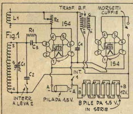
Lo schema elettrico, fig. 1 e lo schema dei collegamenti, fig. 2, illustrano tutti i particolari del circuito. Il costruttore dovrà riscontrare ogni collegamento su ambedue gli schemi per esser certo di non aver fatto errori, soprattutto se non ha l'esperienza necessaria per leggere a prima vista quello elettrico.
