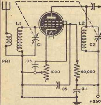
Un amplificatore efficiente e selettivo è mostrato nel nostro schema e può essere semplificato notevolmente mediante la sostituzione dell'insieme L2-C2 con una piccola impedenza di AF. Ciò ridurrà in un certo modo la sensibilità, ma vi sarà contrapposto il vantaggio di un solo condensatore di sintonia. Come valvola
