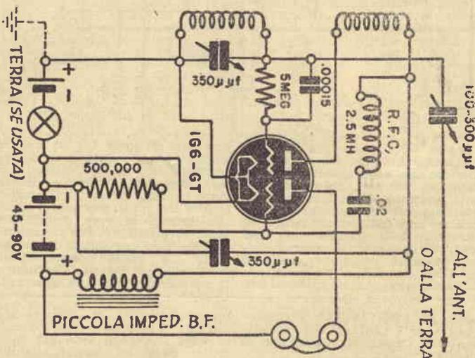
Un circuito del tipo da lei richiesto può essere realizzato usando una 1G6-GT secondo lo schema qui illustrato. Come bobina può usare una ordinaria bobina con 4 piedini, che troverà in commercio già pronta. Dato che l'apparecchio deve funzionare con un basso vol-
